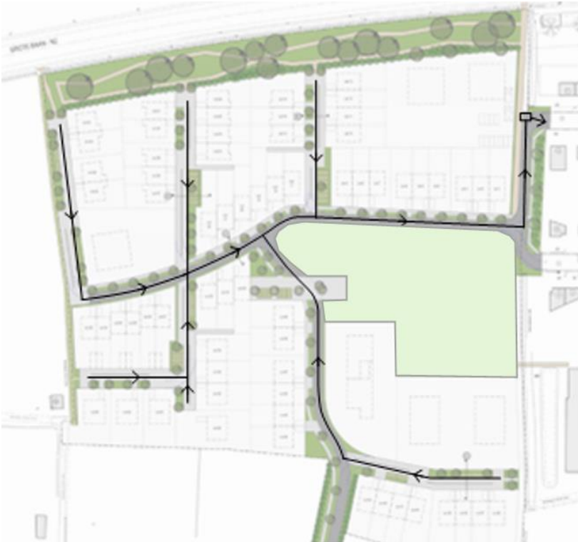
Figuur 3-2: Schematische weergave van de nieuwe riolering (DWA) in het projectgebied
