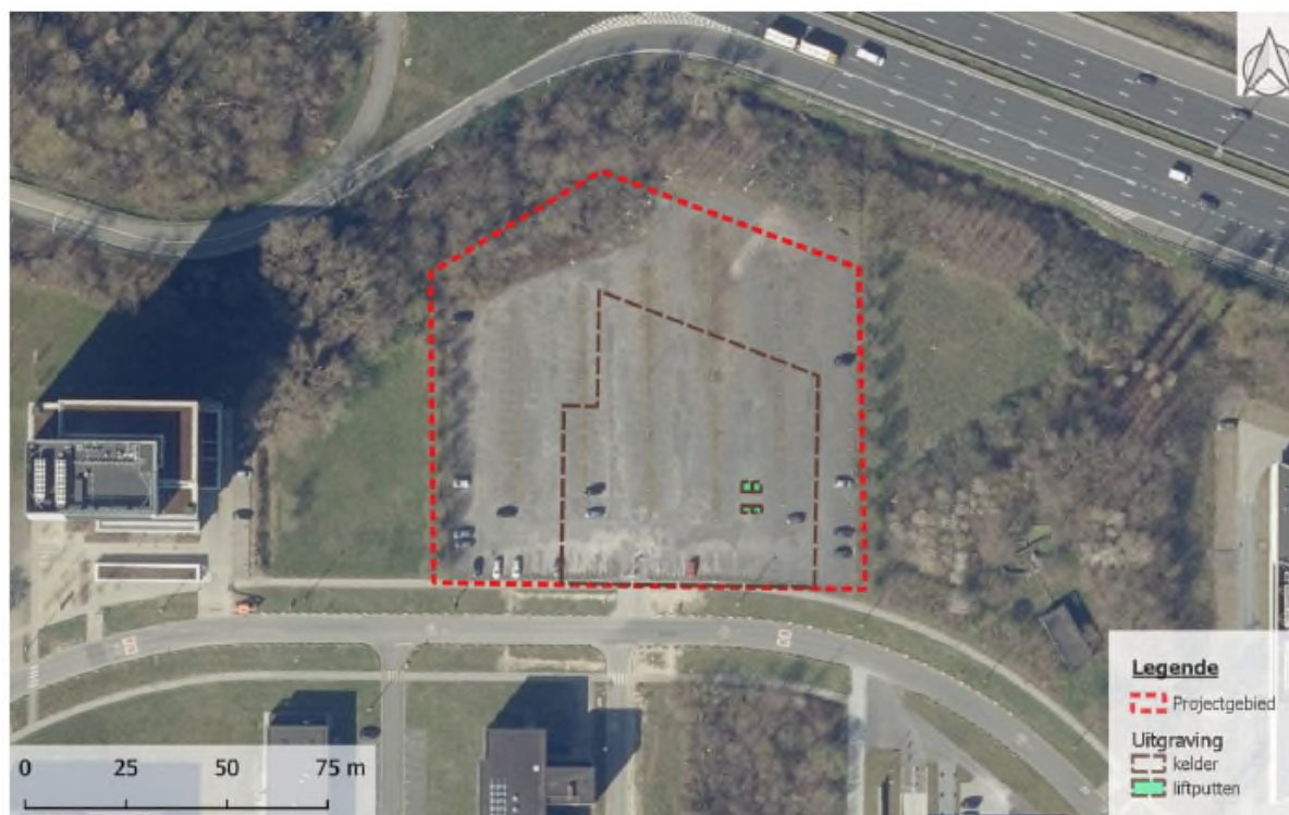
Figuur IV-2: Contour van de bouwput – uitgraving kelder
