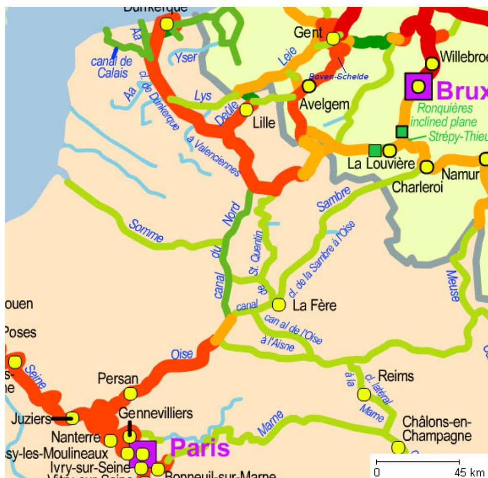
Figuur 5.1: Situering van de relevant rivieren en kanalen in het kader van de Seine-Schelde verbinding (legende figuur: rood = klasse V schepen; oranje = klasse IV; donkergroen = klasse III; heldergroen = klasse II; lichtgroen = klasse I; blauw = waterwegen die niet bestemd zijn voor transport)
